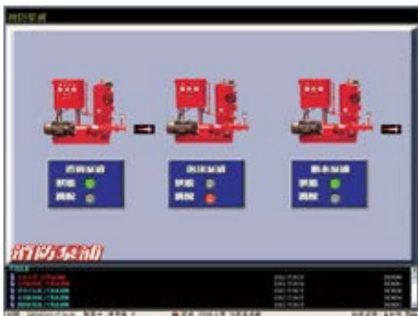
↑ 消防泵浦偵測（揚水、泡沫、灑水）
