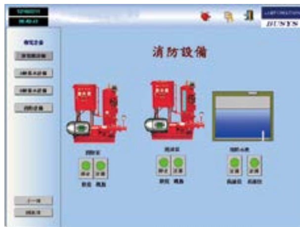
↑ 消防泵浦偵測（揚水、泡沫、水箱水位）
