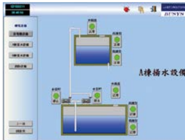
↑ 地下室／屋頂清水水箱水位、水箱蓋及揚水泵浦偵測
